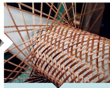
Acima à esquerda: O tubo interior branco de uma mangueira passa pelo processo de reforço. O reforço, chamado trança, dá à mangueira resistência à pressão e estabilidade.
